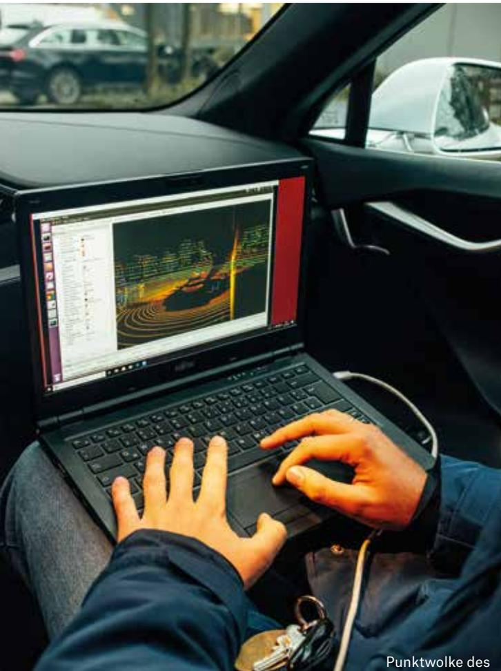
Punktwolke des rotierenden Laserscanners: Das wissenschaftliche Team überprüft andauernd die korrekte Funktionsweise der Sensorik während der Fahrt auf Teststrecken
