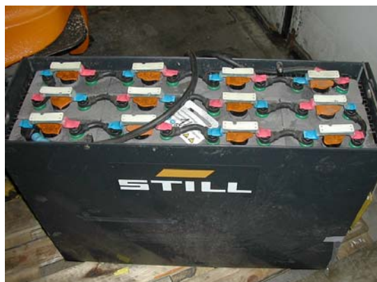
Bild 1: Traktionsbatterie für Gabelstapler mit Versuchssensoren der Klasse 1 [12]
