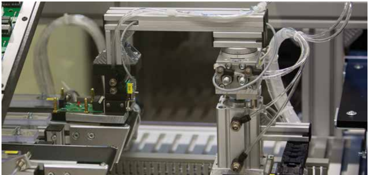
Übergabehandling an Transfersystem
