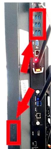
Sie haben auch die Möglichkeit, einen eigenen Computer an das Clevertouch anzuschließen und das Gerät als Display für Ihren Computer zu nutzen. Dafür verwenden Sie die beschrifteten Schnittstellen auf der rechten Seite des Gehäuses. Sie benötigen eine Verbindung für die Übertragung des Videosignals. Wir empfehlen Ihnen die Verwendung des HDMI-Kabels. Nutzen Sie darüber hinaus das USB-Kabel, falls Sie Ihren mitgebrachten Computer mit Finger- oder Stifteingabe über das Display bedienen möchten.
