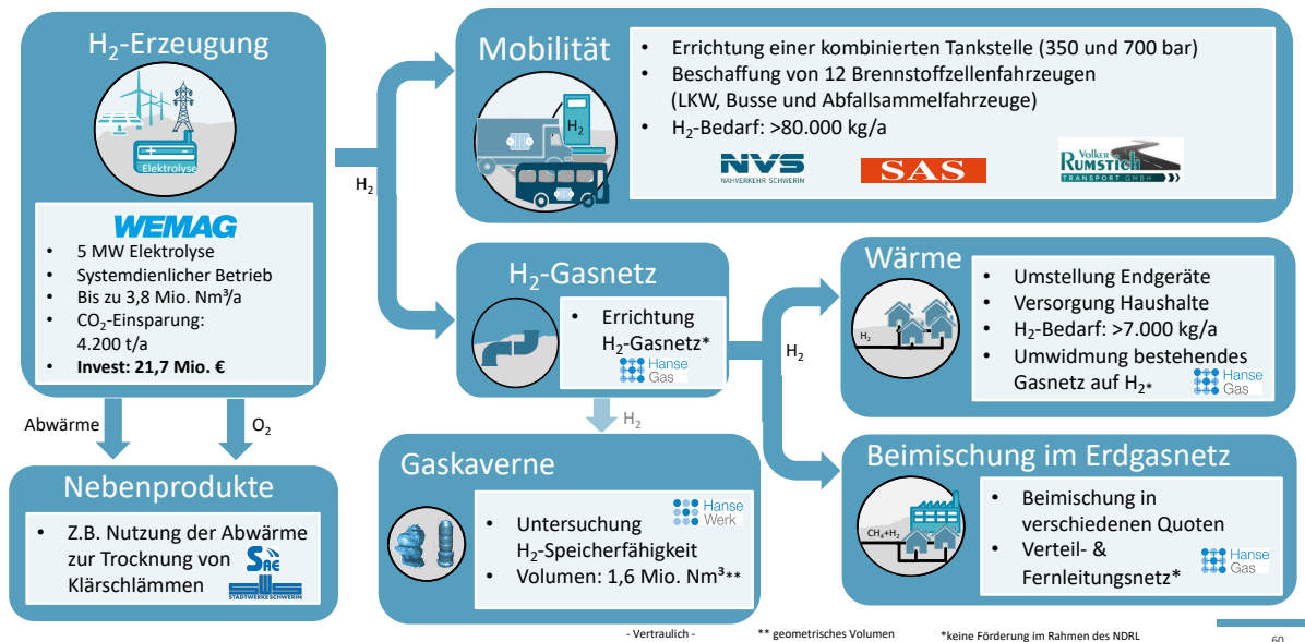
Abb. 12 Im Hub MV steht die Speicherung von Wasserstoff ebenso im Fokus wie dessen Nutzung in der Mobilität
