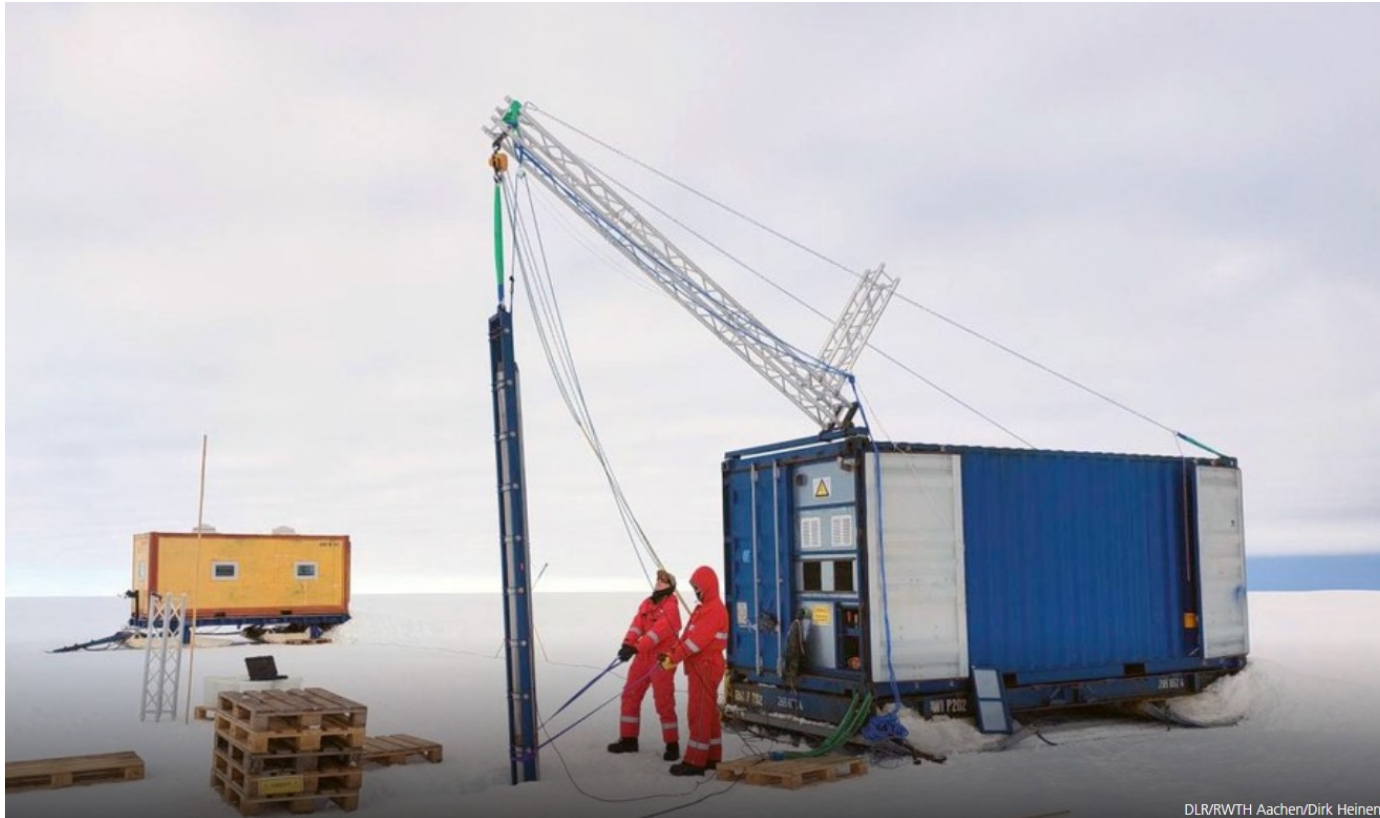
Schmelzsonde IceCraft-1 2023 in der Nähe der Neumayer Station
