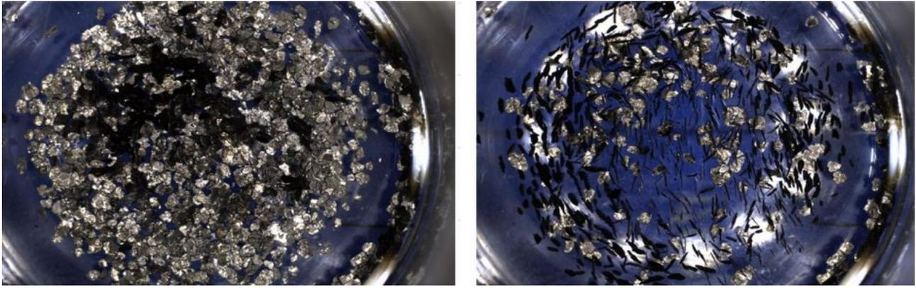
Mit Nanopartikeln funktionalisiertes Anodenmaterial (links Rohzustand, rechts Ausrichtung durch ein starkes Magnetfeld)
