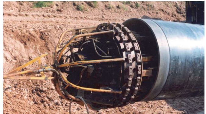
Abbildung 38: Innenzentrier-Vorrichtung für die Fallnahtschweißung von erdverlegten Großrohren
