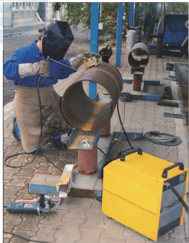
Abbildung 40: Fallnahtschweißen mit zelluloseumhüllten Stabelektroden
