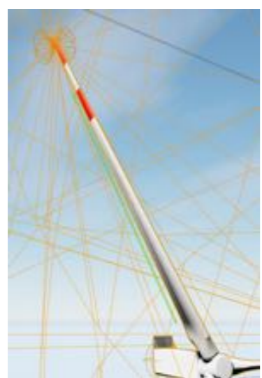
Simulierte Geräuschquellen am WKA-Flügel: Blattspitze (orange) und Blatthinterkante (grün)
