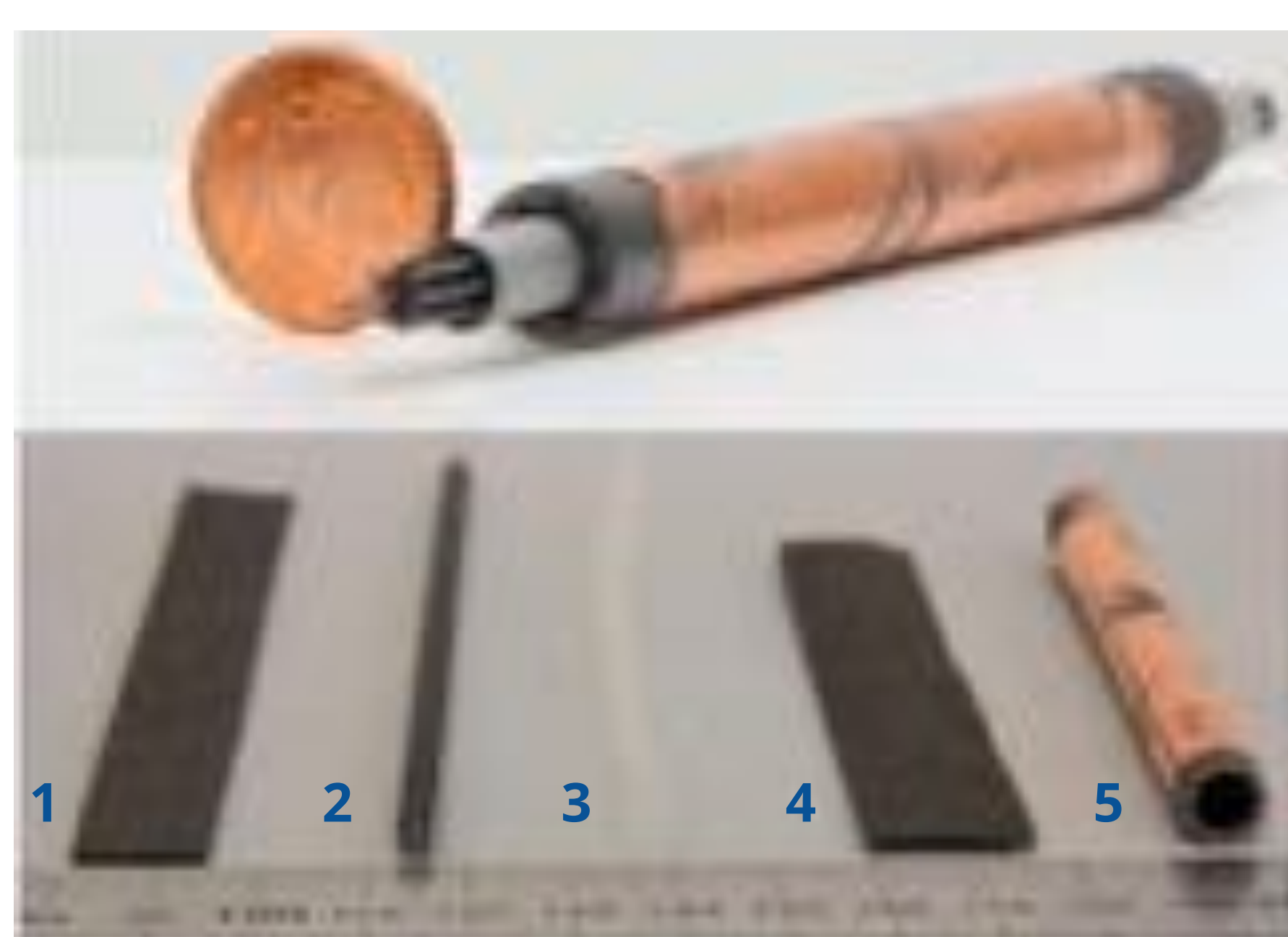
Abb. 3: Tubuläre Einzelzelle und Komponenten [1]
