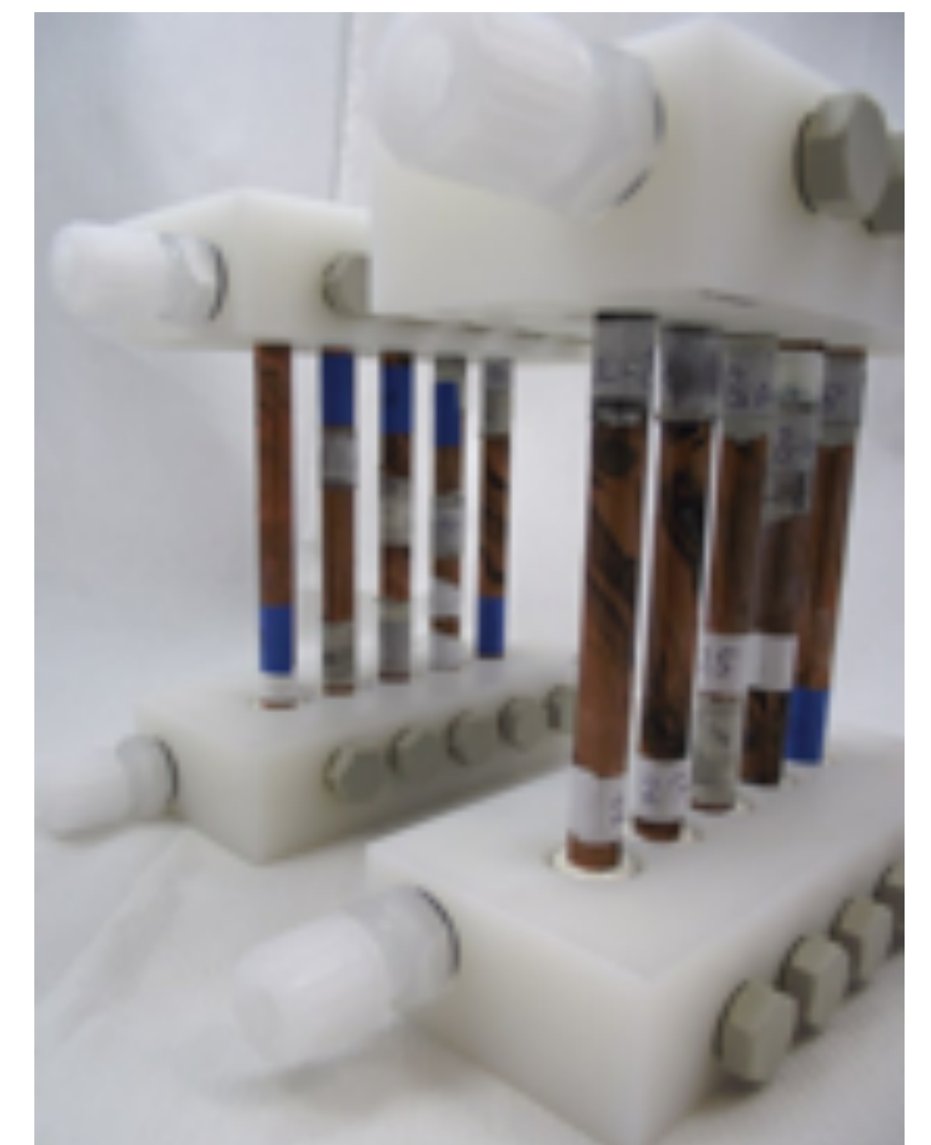
Abb. 5: Modul aus 5 Zellen der aktuellen Generation
