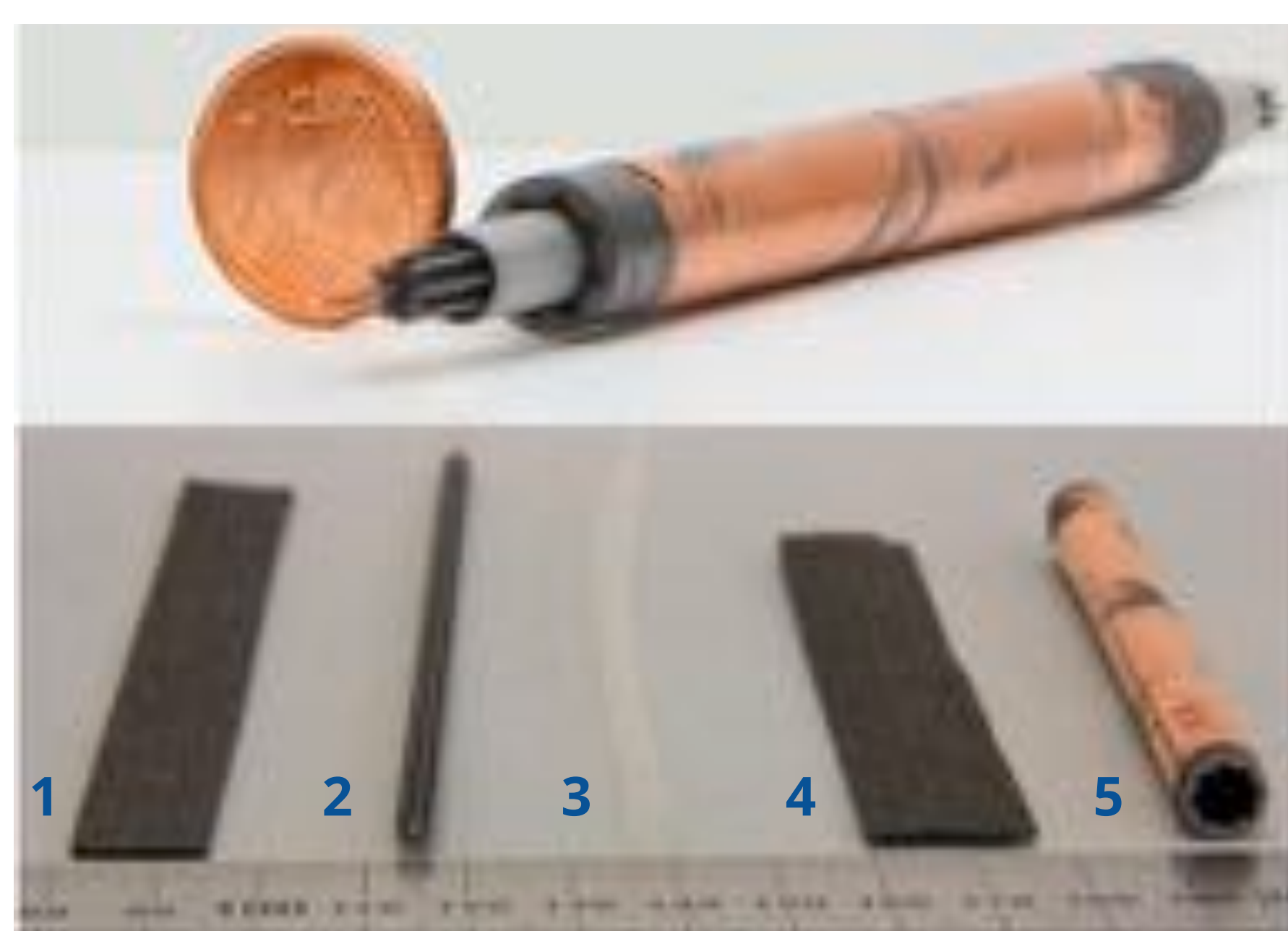
Abb. 3: Tubuläre Einzelzelle und Komponenten [1]
