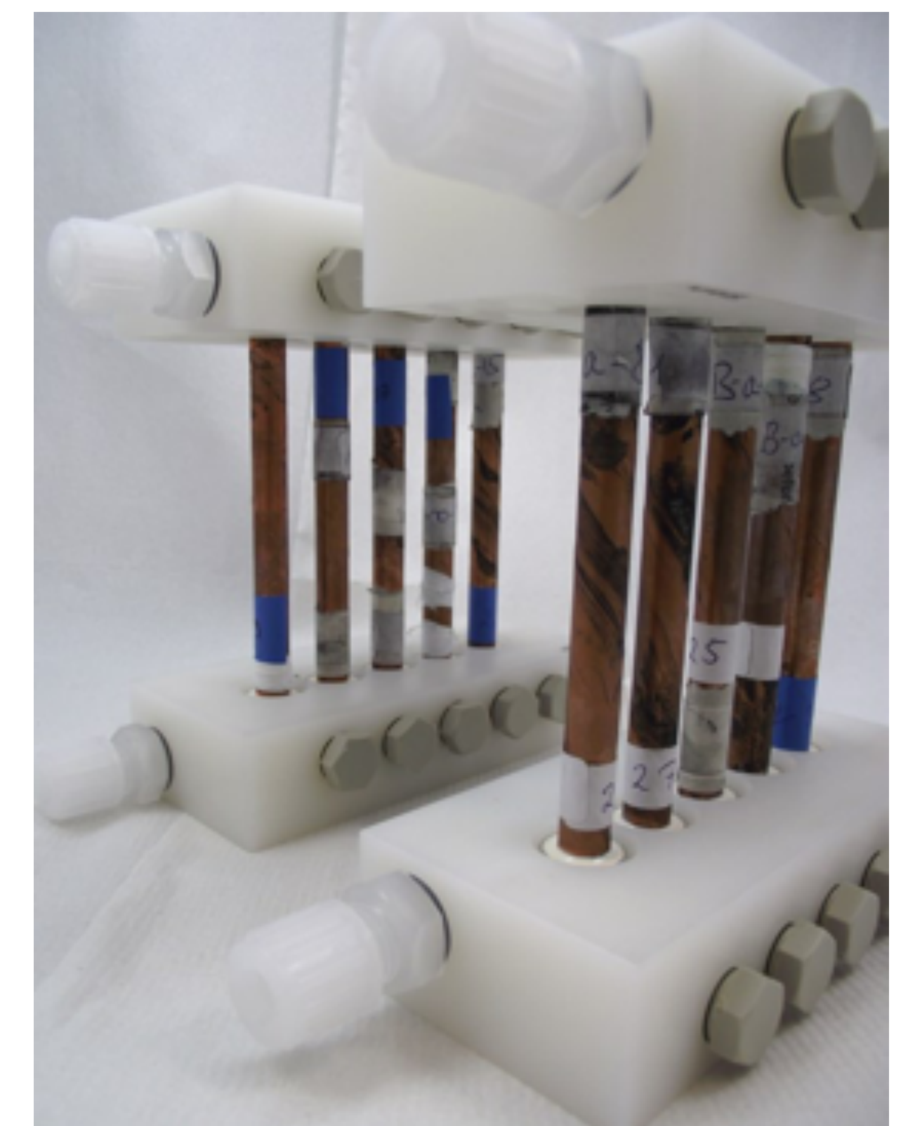
Abb. 5: Modul aus 5 Zellen der aktuellen Generation
