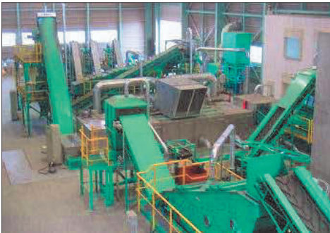
Mechanische Aufbereitung von Shredderrückständen
