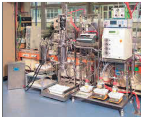
Hochinstrumentierter Bioreaktor zum Aufbau eines globalen Monitoringsystems
