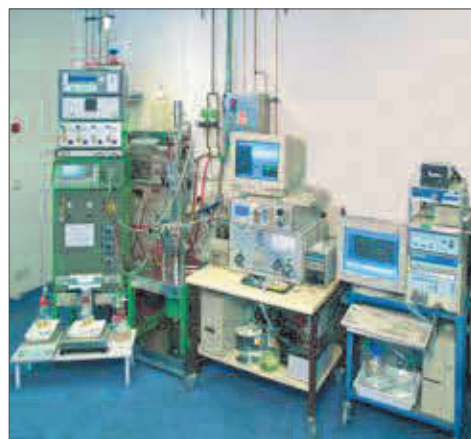
Biostat ED 5 mit erweiterter Instrumentierung zur Untersuchung der Dynamik der Proteinbildung
